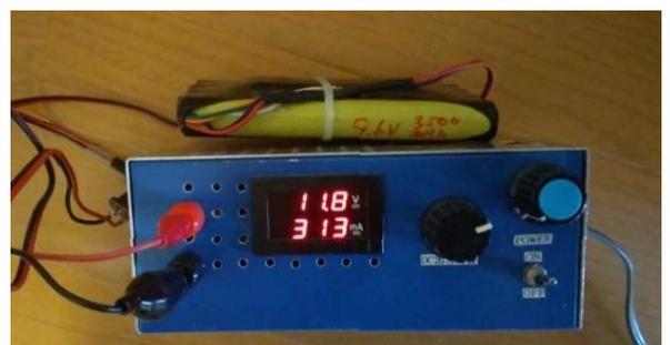
【図3】実験用可変電圧電源。
